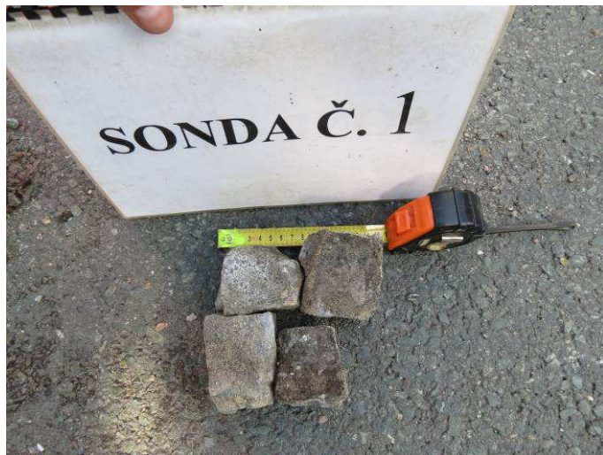
Obr.5.F Sonda č.1 – materiál konstrukční vrstvy
