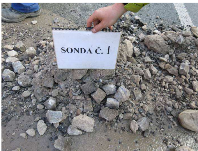
Obr.3.F Sonda č.1 – dlažba
