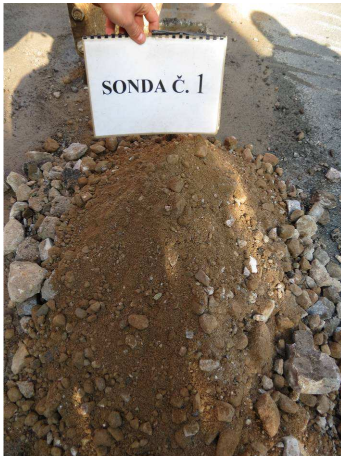
Obr.5.F Sonda č.1 – materiál konstrukční vrstvy
